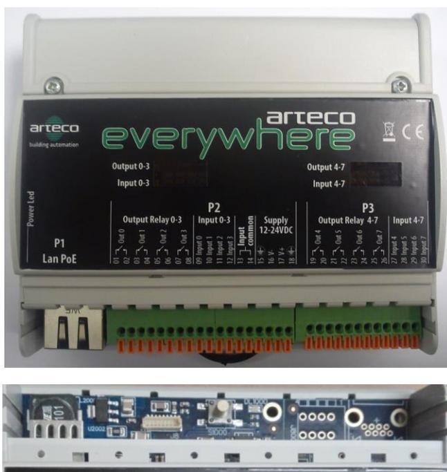
2. Alimentare il modulo (verificare che il led a sinistra del connettore Ethernet lampeggi a circa 1Hz).
